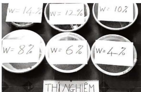
Mẫu xỉ được thực hiện với nhiều thí nghiệm khác nhau. Trong ảnh: Công đoạn thí nghiệm đậm đặc tiêu chuẩn của xỉ FHS.
