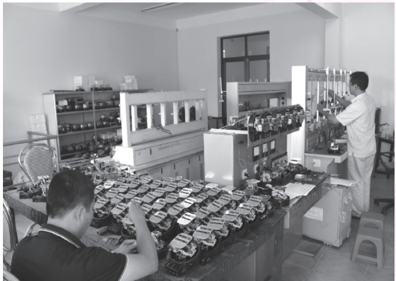
Trung tâm Kỹ thuật tiêu chuẩn đo lường chất lượng được đầu tư cơ sở vật chất, trang thiết bị đồng bộ, từng bước hiện đại, phòng thí nghiệm hiệu chuẩn đạt tiêu chuẩn quốc tế ISO/IEC 17025, đáp ứng yêu cầu thực hiện dịch vụ kỹ thuật về tiêu chuẩn đo lường chất lượng. (Trong ảnh: Kiểm định đồng hồ điện). Anh PV
