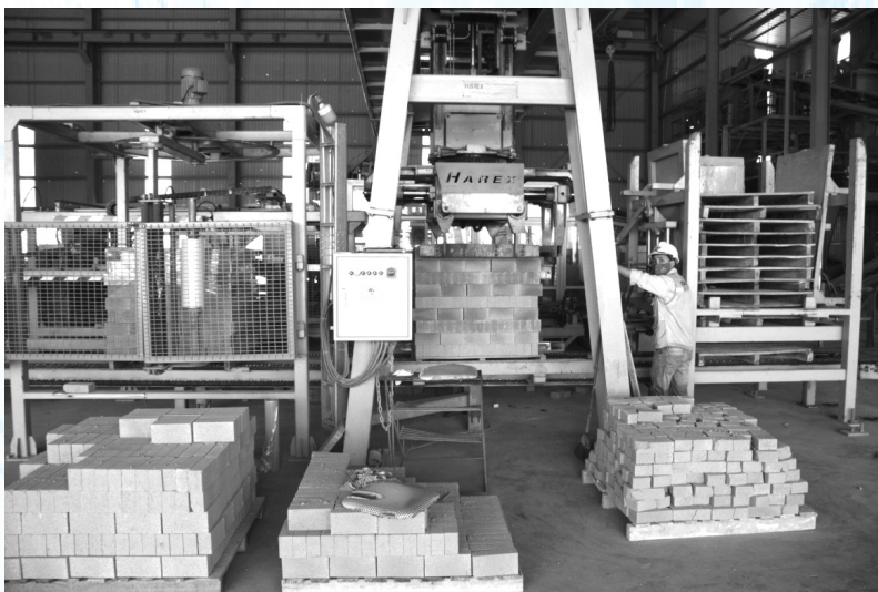
Sản phẩm gạch không nung của Nhà máy sản xuất vật liệu xây dựng Trần Châu được sử dụng 17-20% chất phụ gia là tro bay, tro xỉ của Nhà máy Nhiệt điện Vũng Áng 1; Ảnh: QT
