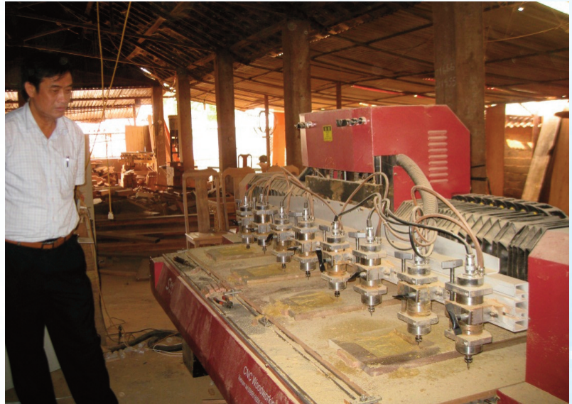
Ứng dụng máy móc thiết bị CNC trong quá trình sản xuất gỗ tại Làng nghề Thái Yên;
