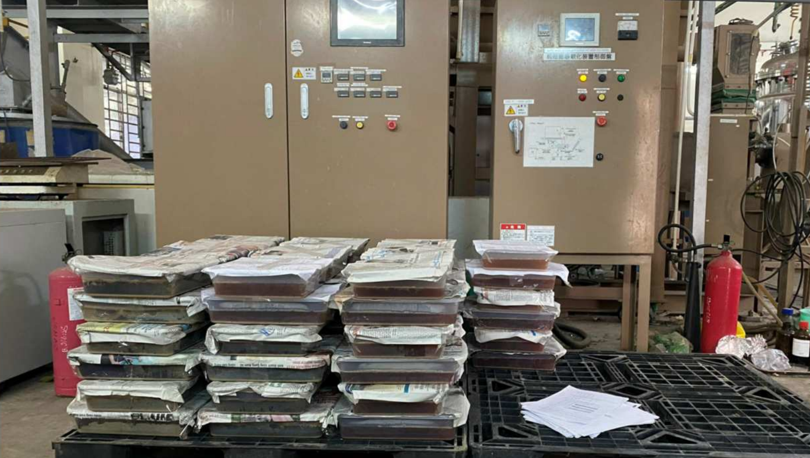
Thử nghiệm pilot lên men BC từ 100kg bùn giấy.
